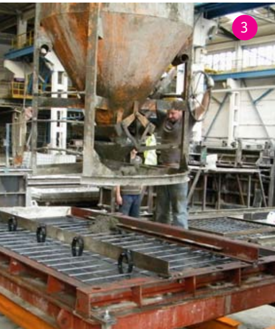
1. Panell Wall — siatka stalowa 2. Nasyp wiaduktu kolejowego, 3. Wylewanie prefabrykatu, 4. Nowy Dwór Mazowiecki, 5. Panel architektoniczny
